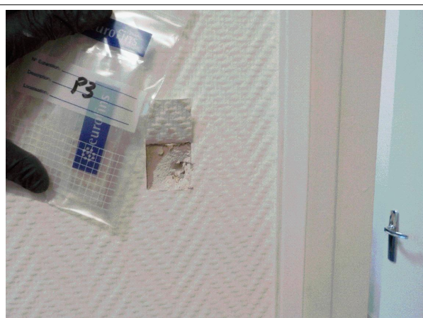
Prélèvement - P003 : R+1 / Bureau 101 - Enduit- (Absence d'amiante)
