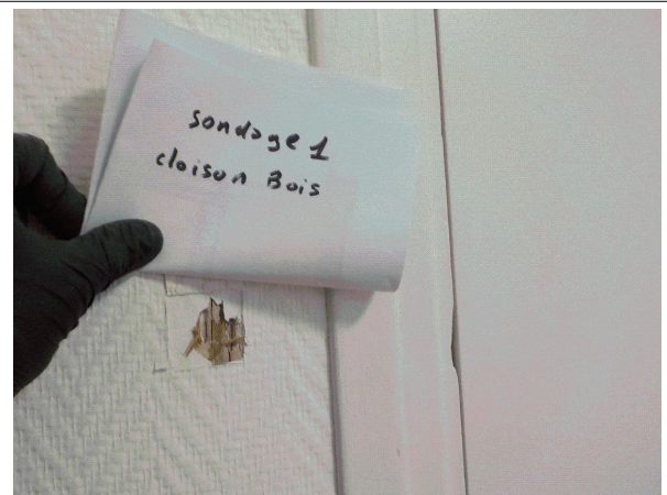
Déclaré - : R+1 / Bureau 101 - Panneau de cloison- (Absence d'amiante)
