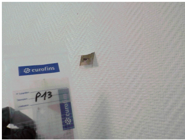
Prélèvement - P013 : R+1 / Bureau 101 - Enduit- (Présence d'amiante)
