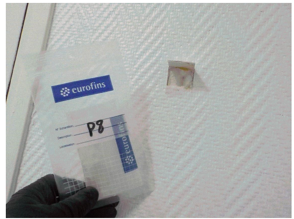
Prélèvement - P008 : R+1 / Bureau 101-1 - Enduit- (Absence d'amiante)
